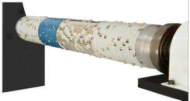
Les barres à frictions ont été étudiées et conçues pour de l'enroulage multipiste. Les anneaux de frictions vous permettent d'enrouler à tension égale chaque bobinaux. Ces derniers frictionnent lorsque la tension est trop importante et permettent de réguler individuellement la tension exercée sur chaque bobinaux.
