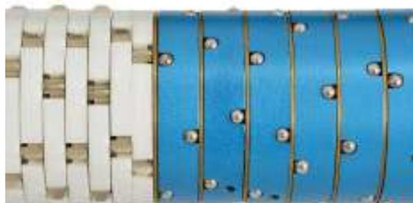
Les barres à friction ont été étudiées et conçues pour de l'enroulage multipiste. Les anneaux de friction vous permettent d'enrouler à tension égale chaque bobineaux. Ces derniers frictionnent lorsque la tension est trop importante et permettent de réguler individuellement la tension exercée sur chaque bobineaux.
