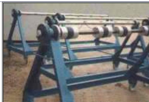
Lève Bobine Mécano-Pneumatique ou Mécanique
