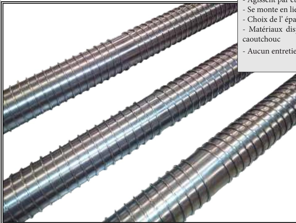
La vis élargisseuse vient en complément des cylindres de déplissage et donne une constance à l'étirement de la matière afin que des plis ne se forment pas.
