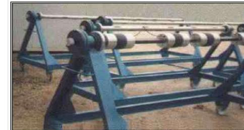
Rollenheber, pneumo-mechanisch oder mechanisch
