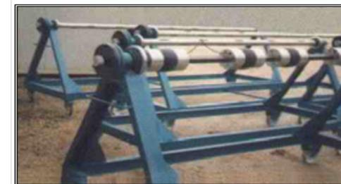
Lèves Bobines Mécano-Pneumatique ou Mécanique
