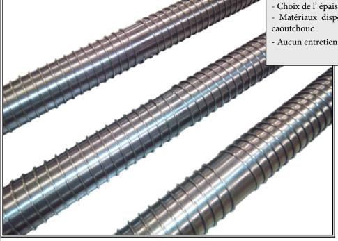
La vis élargisseuse vient en complement des cylindres de déplissage et donne une constance à l'étirement de la matière afin que des plis ne se forment pas.
