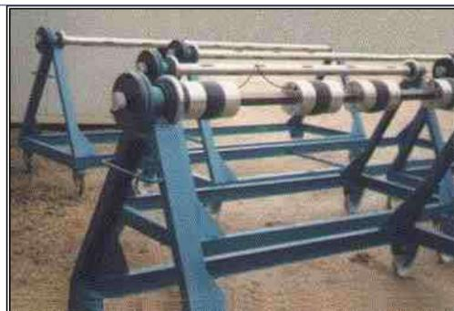
Lève Bobine Mécano-Pneumatique ou Mécanique
