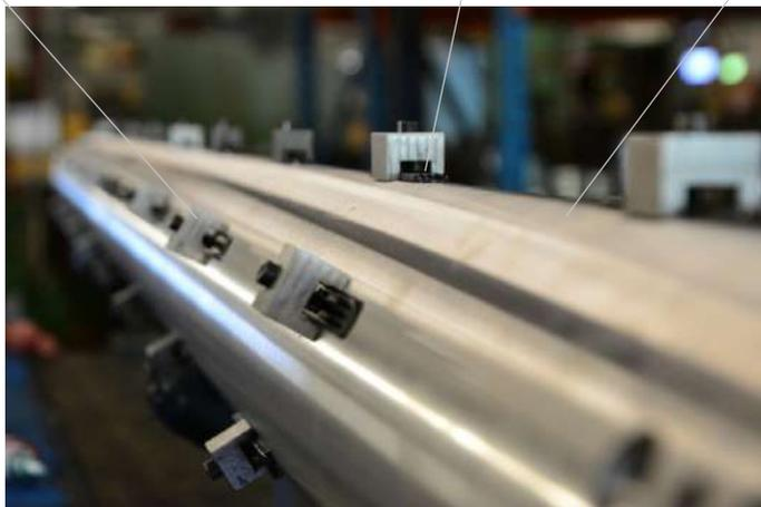
étape 2 - Démontez les vis situées aux extrémités de la barre sur le diamètre extérieur ainsi que la valve de gonflage.
